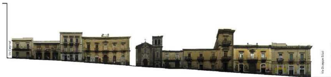
Fig.13 – Foto-raddrizzamento dei prospetti degli aggregati
